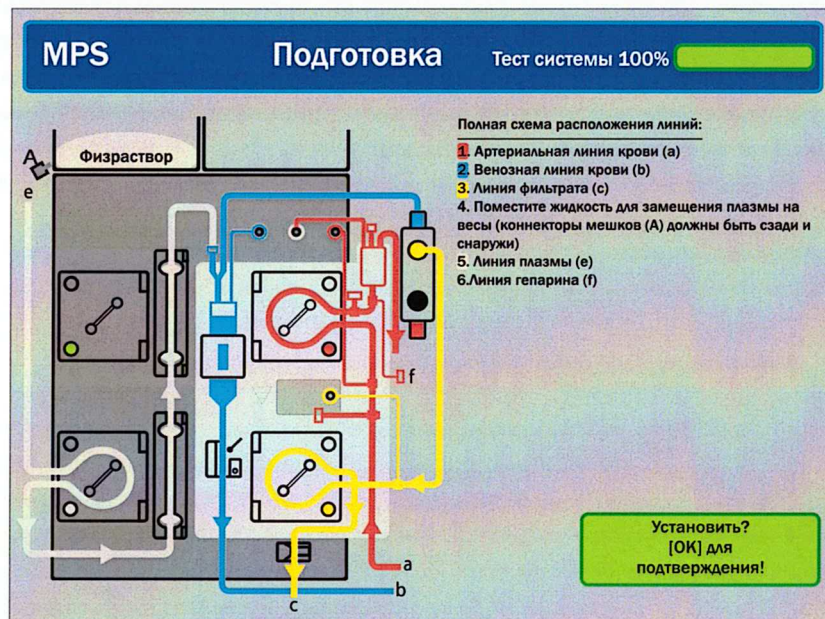
Рисунки 8а и 8б. Установка экстракорпорального контура: артериальной сегмент (забор крови), венозной сегмент (возврат крови), сегмент фильтра та и сегмент субституата/замещающего раствора для плазмосепарации - MPS Substitute system multiFiltrate.
