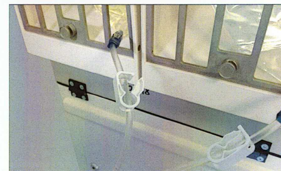
Рисунок 16. Размещение мешка с замещающим раствором альбумина на весах II гемопроцессора.
